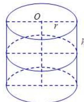
16. Từ một tấm thép phẳng hình chữ nhật, người ta muốn làm một chiếc thùng đựng dầu hình trụ bằng cách cắt ra hai hình tròn bằng nhau và một hình chữ nhật sau đó hàn kín lại, như trong hình vẽ dưới đây. Hai hình tròn làm hai mặt đáy, hình chữ nhật làm thành mặt xung quanh của thùng đựng dầu. Biết thùng đựng dầu có thể tích bằng 50,24 lít. Tính diện tích của tấm thép hình chữ nhật ban đầu.
